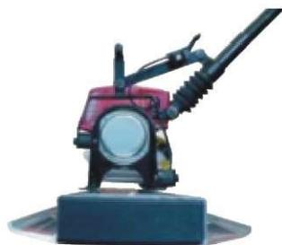
Zaoblená lišta je speciálně konstruována pro rozhrnování betonové směsi při pohybu vpřed i vzad. Výsledná rovinnost a kvalita povrchu je v některých případech na takové úrovni, že již není třeba dohlazovat
